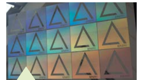
Texturation d'une surface étendue de 750x450 mm 2
